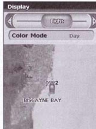
Pomocí šipek vlevo a vpravo na kurzorové klávesy ROCKER nastavte podsvícení do požadované úrovni.
